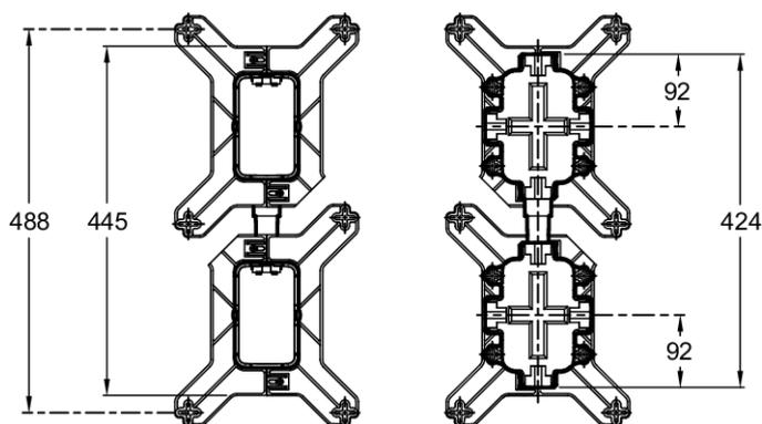
Descripción: Kit para alinear dos cajas empotradas. 98788D. Colección: MODULO. PESO: 0,3 kg. MATERIAL: N/A. Instalar para conectar dos cajas de módulo 98699D.
