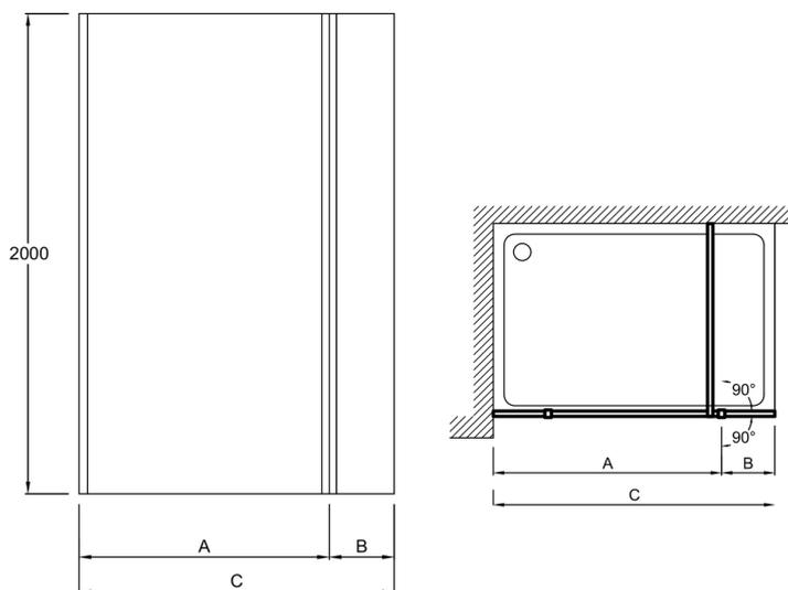
Descripción: Panel fijo - con minipanel. CE22W90BWP. Colección: CONTRA. DIMENSIÓN: 200 x 90 cm. PESO: 58 kg. MATERIAL: Vidrio transparente. TIPO DE INSTALACIÓN: Mural. LONGITUD MIN/MAX EN CM: 127 - 129. INSTALACIÓN: Reversible. ESPACIO DE VIDRIO EN MM: 8. ALTURA DE LAS MAMPARAS EN CM: 200. RETORNO: 40 cm. DESCRIPCIÓN: La referencia incluye panel fijo, minipanel móvil y barra de refuerzo.. SEGURIDAD: Vidrio transparente de seguridad 8 mm.. OBLIGATORIO: Instalar con una barra de refuerzo..
