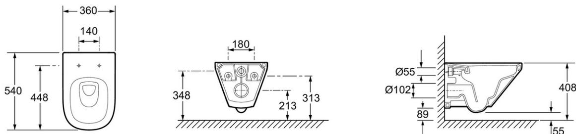
Descripción: Inodoro suspendido sin brida. CE77725. Colección: MODERN LIFE. DIMENSIÓN: 54 x 36 cm. PESO: 58,4 kg. MATERIAL: Cerámica. TIPO DE INSTALACIÓN: Suspendido. MATERIAL DEL ASIENTO: Termodoro. TIPO DE BRIDA: Sin brida. TIPO DE ASIENTO: Extra plano. ASIENTO: Descenso progresivo y desmontable. BISAGRAS: Metálicas inoxidables. GARANTÍA DE LA CERÁMICA: 10 años. GARANTÍA DEL ASIENTO: 2 años.
