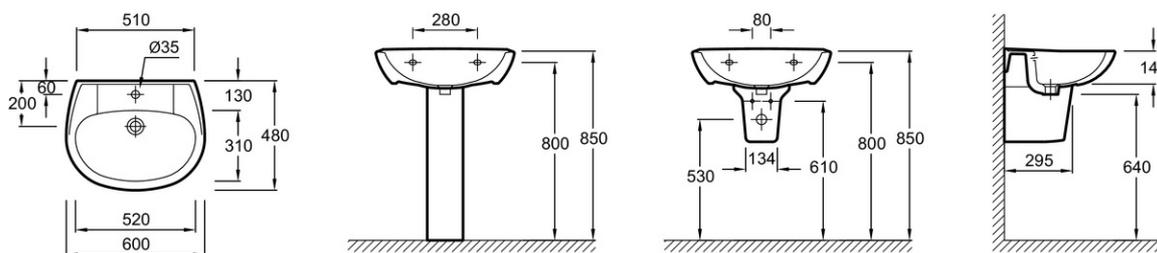
Descripción: Lavabo 60 cm, autoportante. E1286F. Colección: HUNO. DIMENSIÓN: 60 x 48 cm. PESO: 14,2 kg. MATERIAL: Cerámica. TIPO DE INSTALACIÓN: Autoportante. MECANISMO: Estándar. SIFÓN RECOMENDADO: Kit de fijaciones incluido. ORIFICIO DE GRIFERÍA: 1 orificio para grifería. REBOSADERO: Con orificio de rebosadero. NÚMERO DE POZAS: 1. GRIFERÍA RECOMENDADA: E75760. Con fijaciones. Para instalación sin mueble.
