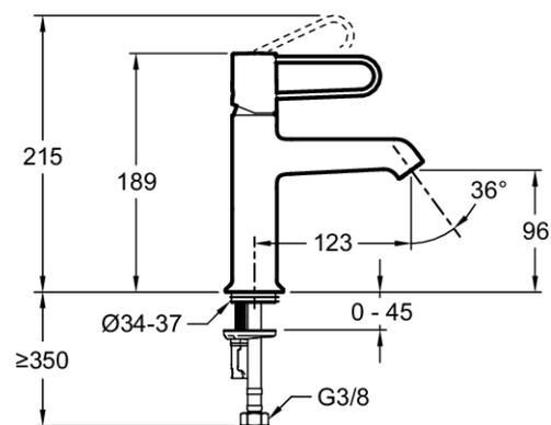
Descripción: Monomando de lavabo sin desagüe. E21029-BL. Colección: ODÉON RIVE GAUCHE. DIMENSIÓN: 18,90 x 4,50 cm. PESO: 1,0 kg. MATERIAL: N/A. TIPO DE INSTALACIÓN: 1 orificio. TIPO: Monomando. CAUDAL: 5 l/mn. ALTURA TOTAL DE LA GRIFERÍA: 189. SALIDA DE CAÑO: 123. RACORES: Con flexibles de alimentación. MÉCANISMO: Cartucho de discos cerámicos. DESAGÜE: Sin desagüe.
