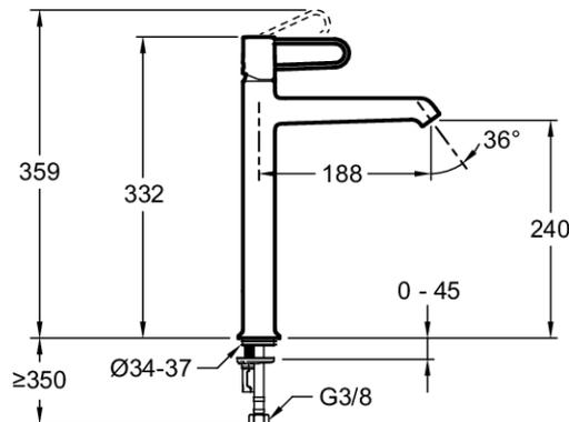
Descripción: Monomando de lavabo sin desagüe, caño alto. E21031-GLD. Colección: ODÉON RIVE GAUCHE. DIMENSIÓN: 27,30 x 4,50 cm. PESO: 1,7 kg. MATERIAL: N/A. TIPO DE INSTALACIÓN: 1 orificio. TIPO: Monomando. CAUDAL: 5 l/mn. ALTURA TOTAL DE LA GRIFERÍA: 332. SALIDA DE CAÑO: 188. RACORES: Con flexibles de alimentación. MÉCANISMO: Cartucho de discos cerámicos. DESAGÜE: Sin desagüe.
