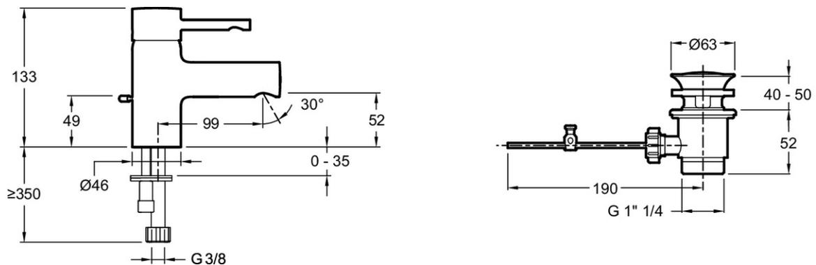
Descripción: Monomando lavabo - modelo estándar - desagüe automático. E37301. Colección: CUFF. PESO: 1,3 kg. MATERIAL: N/A. TIPO DE INSTALACIÓN: 2 orificios. TIPO: Monomando. CAUDAL: 5 l/min. ALTURA TOTAL DE LA GRIFERÍA: 133. SALIDA DE CAÑO: 99. RACORES: Con flexibles de alimentación. Monomando de lavabo. Desagüe automático. Caudal: 5 l/min.
