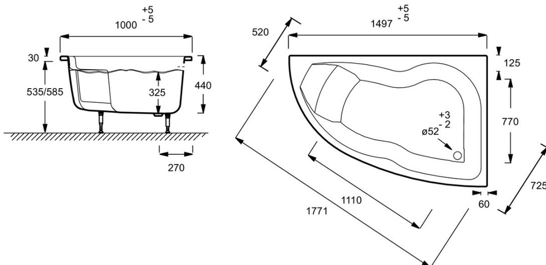
Descripción: Bañera acrílica asimétrica - Versión derecha. E60218. Colección: MICROMÉGA DUO. DIMENSIÓN: 150 x 100 x 44 cm. PESO: 19 kg. MATERIAL: Acrílico. TIPO DE INSTALACIÓN: A ángulo. ALTURA DE AGUA: De 12,3 a 17 cm. ALTURA DE PASO: 32,5 cm. VOLUMEN (L): 205/135. ALTURA DEL PIE: 5,2 cm. INFORMACIÓN ADICIONAL: Angular. VERSIÓN: derecha. Modelo asimétrico: versión derecha. Pies regulables de fácil instalación gracias al sistema Quick Clip. Apoya-cabeza integrado..
